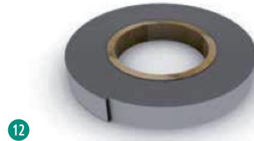
**Foto 12** - La cinta de expansión (Tape 4 mm) se debe utilizar en todos los encuentros del sistema con elementos de fachada que puedan tener diferente coeficiente de dilatación: vierteaguas metálicos, vigas sobresalientes en aleros, conductos de salida de humos y de ventilación, esperas de elementos empotrados, etc. para evitar el agrietamiento del encuentro y pérdida de impermeabilización por movimientos diferenciados e indeseados.
